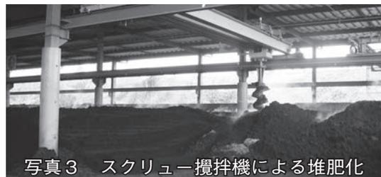
写真3 スクリュー攪拌機による堆肥化
